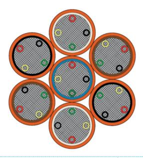
Utilisation: Câble symétrique à haute flexibilité. Rayon de courbure minimal (facile à enrouler même dans les espaces restreints) et performances électriques de haute qualité (faible chute de tension et faible déséquilibre de tension). Peut être utilisé sur de grandes longueurs.
